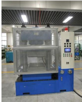
主要用于各种树脂结合剂金刚石制品砂轮、弹性磨块、软磨片等的热压成型。该产品通过对加热系统的改进，提高了压机的加热温度，可以满足客户对高温度产品的加工需求。
