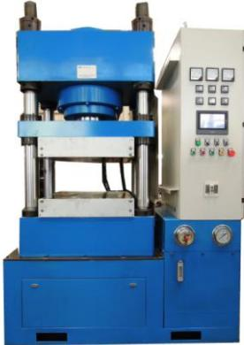
主要用于各种树脂结合剂金刚石制品砂轮、弹性磨块、软磨片等的热压成型。通过加热系统的优化设计，保证了加热台面的温度均匀性。采用伺服压力控制系统，保证压力控制准确。
