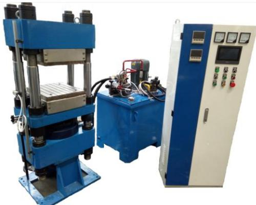
主要用于各种树脂结合剂金刚石制品砂轮、弹性磨块、软磨片等的热压成型。该产品通过对主机结构的改进，提高了压机的压制精度，可以满足客户对高精度产品的加工需求。
