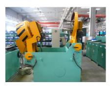
主要用于陶瓷结合剂固结磨具成型料混制。采用逆流混料方式和特殊的拨叉结构,可以快捷、均匀的完成混料。
