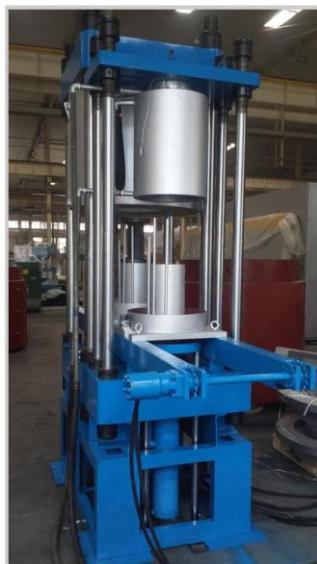
主要用于金属结合剂金刚石锯片、磨轮的烧结成型。该产品采用了全新的结构设计，避免了客户现场的地坑作业，可以适应高、低不同楼层的安放，为客户节省了施工费用。
