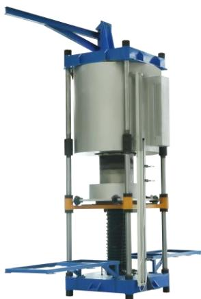
主要用于金属结合剂金刚石锯片、磨轮的烧结成型。可以为产品的成型提供还原和保护气氛，防止产品氧化。采用伺服压力控制系统，压力控制准确。采用新型纳米陶瓷隔热材料，保证烧结温度的均匀性。
