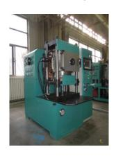
主要用于金属结合剂金刚石制品串珠、刀头等的热压烧结成型。配备真空装置, 产品可在真空环境下烧结,极大减小产品的氧化,提高产品的质量,节省模具损 耗。
